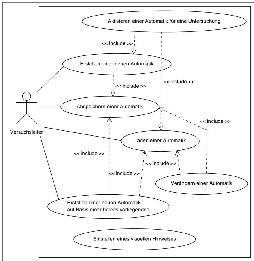
Abbildung 12: Use-Case-Diagramm des Automaten-GUI
